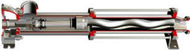
Serie DXC rappresenta la pompa sanitaria a snodo standard della serie DN. E' la soluzione che abbina ottime caratteristiche di sanificabilità grazie al design di casing completamente privi di zone morte e ristagni alle performance dello snodo a spinotto brevettato della serie Diamond.
